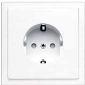
Розетка с заземляющим контактом (тип E) 16 А, 250 В~ (ШхВхГ) 86,1 x 86,1 x 30,7
